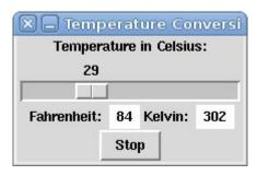
Ein Schieberegler wird durch das Widget Scale realisiert, das als Parameter das Minimum und Maximum der einzustellenden Werte erhält. Einem Schieberegler kann man mit dem Konfigurationsparameter Cmd auch einen Event-Handler zuordnen, der immer dann aktiviert wird, wenn sich an dem Wert des Schiebereglers etwas ändert. Damit können wir diese GUI wie folgt implementieren:
