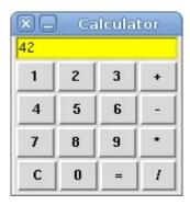
Das Besondere an diesem Beispiel ist die Anforderung, dass die GUI auch einen internen Zustand halten muss, der von den Event Handlern berücksichtigt wird. Zum Beispiel muss bei Drücken der Taste "=" in der Anzeige das Ergebnis erscheinen, das natürlich von den zuvor gedrückten Tasten abhängig ist.
