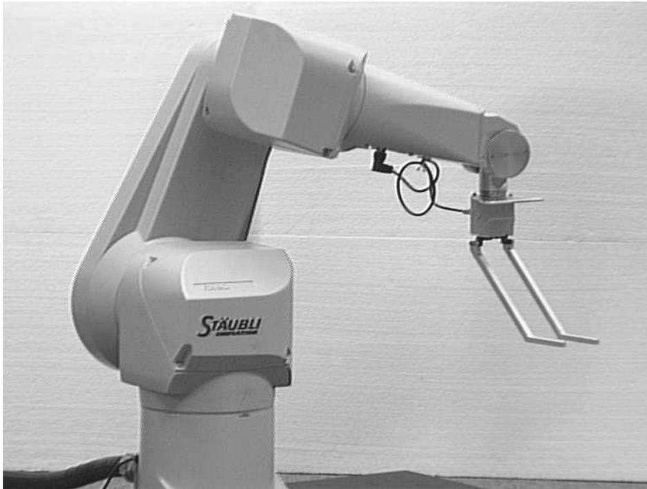
Abbildung 15: Artikulation-Roboter mit sechs Drehgelenken.
