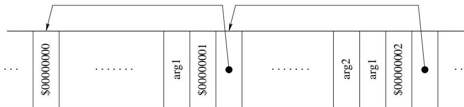
Die Frame-Einträge (arg1, arg2) werden genauso codiert, wie die Elemente des S-Stack.
