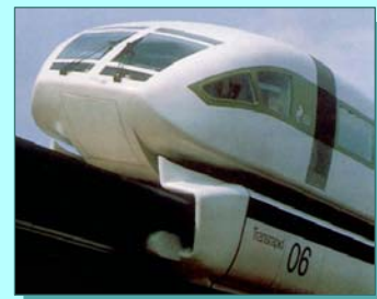
Magnetschwebebahn "Transrapid" Bei der Magnetschwebebahn werden die Magnetfelder für das Schweben und das Fahren mit Hilfe von Frequenzumrichtern erzeugt.
