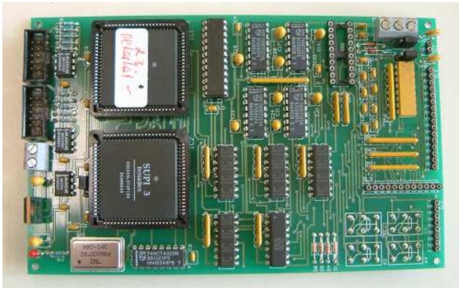
Abbildung C.2: Platine mit zwei Interbus-Slaves
