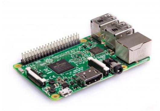
Abbildung 3.2. Raspberry Pi 3 Model B
